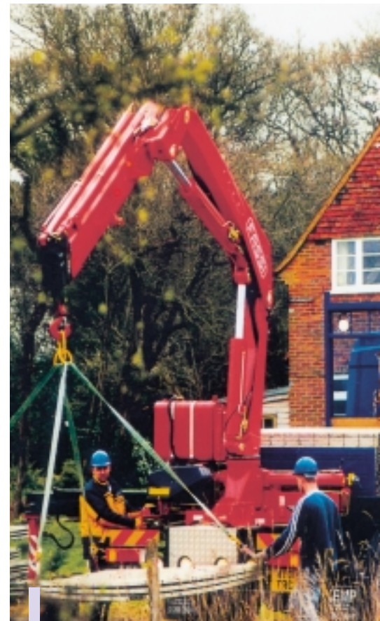
Der Langarmkran F170AS ist ein Baustoffkran der vor allem im deutschen Markt Akzeptanz hat.
