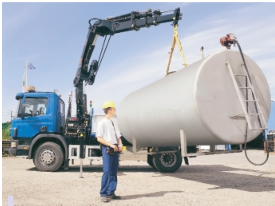
Mit einer Kapazität von 11 Metertonnen und einer Reichweite bis zu 15,1 m eignet sich der XS 122 CL für alle Be- und Entladeaufgaben.
