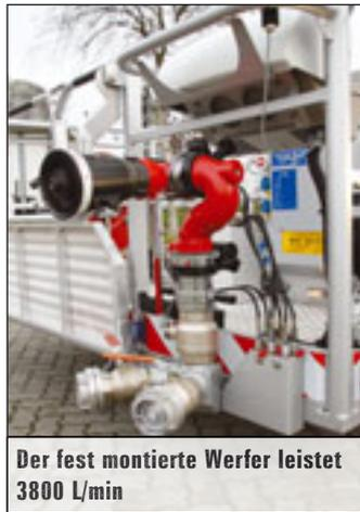
Der fest montierte Werfer leistet 3800 L/min
