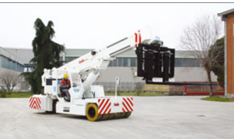
Der elektrogetriebene Valla 400 E mit 40 Tonnen Maximallast
