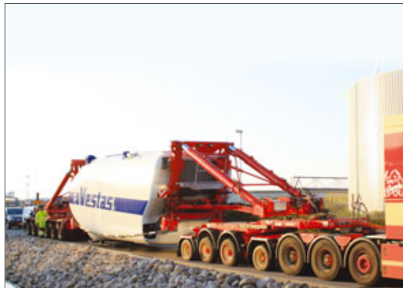
Auf satte 50 Tonnen Achslast ausgelegt, der Goldhofer PST/ES-E
