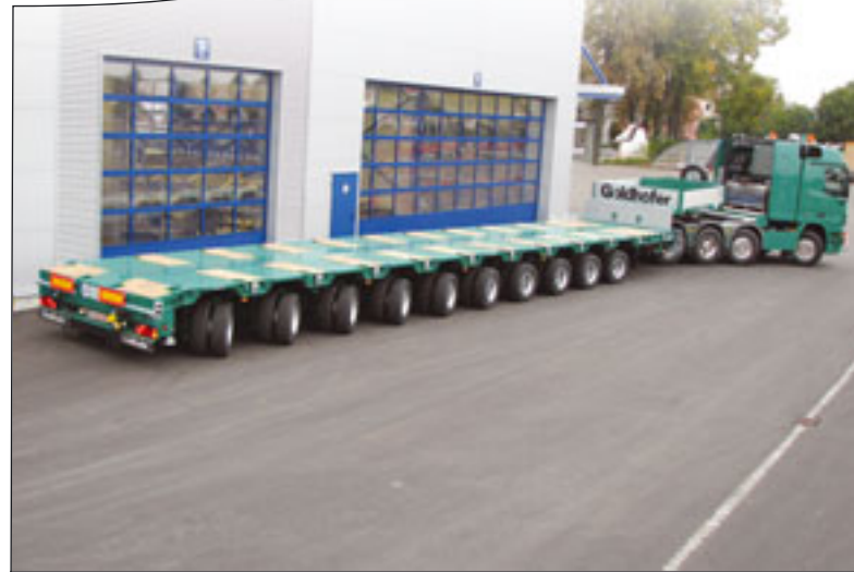
Über 100 Tonnen Nutzlast sind mit dem neuen STZ-H10 von Goldhofer realisierbar
