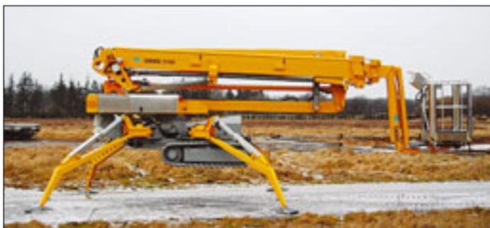
Der dänische Hersteller Omme Lift hat eine neue Raupenarbeitsbühne Typ 2750 RBDJ vorgestellt. Sie bietet 27,5 Meter Arbeitshöhe bei 200 Kilogramm Korblast. Die Reichweite liegt bei maximal 15,5 Metern. Daraus resultieren 10,5 Meter „up and over capability“, also freies Übergreifen zum Arbeiten über Hindernissen. Die Steigfähigkeit der Bühne beträgt 35 Prozent, was 19,3
