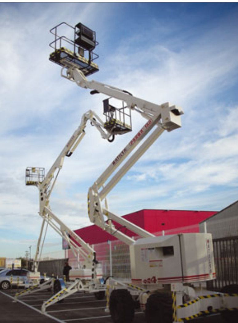
Matilsa baut als bisher einziger Hersteller Allradgelenkteleskopbühnen mit Abstützungen
