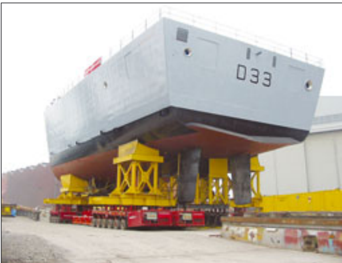
Das Rumpsegment unterwegs zum Pier: die SPS-gesteuerten Hebesysteme garantieren, dass während des Transports die internen Kräfte im Schiffsrumpf aufrecht erhalten bleiben
