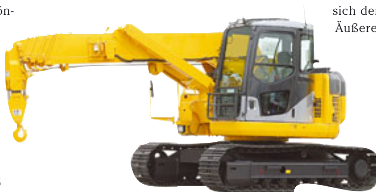
Ein solcher Maeda LC 1385M-8B mit einer Tragkraft von sechs Tonnen steht bald in den Diensten von Uplifter
