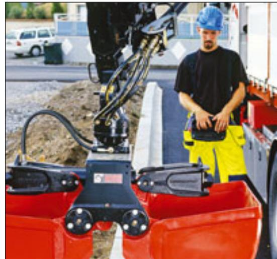
Proportional steuert die neue Version der Fernsteuerung „CombiDrive2“ 32 Funktionen sowie 12 Ein- und Ausschalt-Funktionen. Die Bündelung sämtlicher Funktionen erfolgt laut Hiab intuitiv mit anpassungsfähigen Menüs. Das System kommuniziert drahtlos mit dem Kran via Bluetooth. Die Bat-
