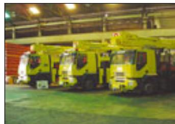
■ An den britischen Vermieter Nationwide Platforms sind nun zwei LKW-Arbeitsbühnen vom Typ T580 ausgeliefert worden. Sie sind mit Film- und TV-Equipment ausgestattet. **Ruthmanns** T580 bietet 500 Kilogramm Tragkraft, gepaart mit 40 Metern Reichweite. Unter anderem ist eine um 360 Grad schwenkbare Kameravorrichtung und eine Halterung für Scheinwerfer am Korb angebracht.
