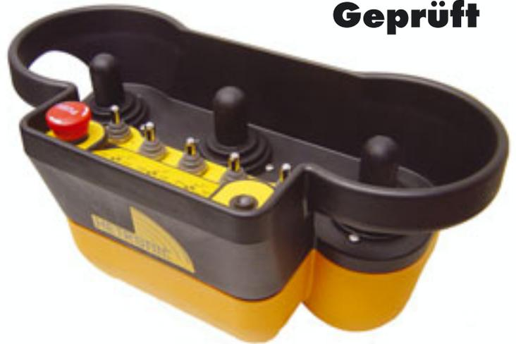
Um die hohen Sicherheitsstandards zu dokumentieren, die allen Funkfernsteuerungen von Hetronic Deutschland zu Grunde liegen, werden zukünftig alle Steuerungen der *Premium Class* nach EN13849 und EN 62061 vom TÜV-Nord zertifiziert (im Bild die Nova XL). Die IEC
