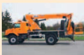
↑ **GSR** hat eine 20-Meter-Teleskoparbeitsbühne vom Typ E200TJ auf einen 12-Tonnen Mercedes Zetros 1833 aufgebaut. Die Maschine ist für seinen deutschen Händler Rothlehner montiert worden. Das Geländefahrzeug ist mit
