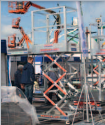
Einen Personenlift als Bausatz: der neue „Genius“ lässt sich auseinander bauen
