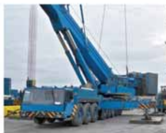
400 t, Liebherr LTM 1400, 1998
