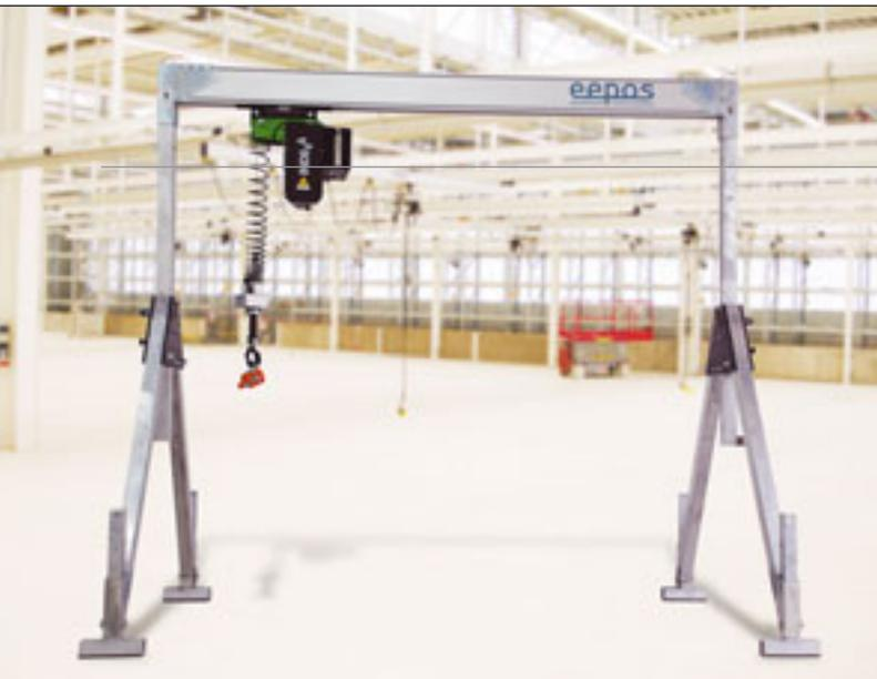
Erstmals stellt die Firma Eepos ein praxisorientiertes Portalkran-Konzept vor, mit dem Unternehmen sehr mobil ein Kransystem mit bis zu 1500 Kilogramm Tragfähigkeit gezielt am Montageort einsetzen können. Die Spannweiten
