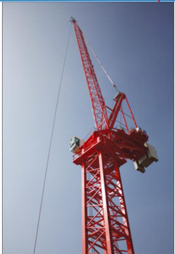
Seinen neuen Wippkran 1250 B mit 60 Tonnen Traglast und bis zu 80 Meter Ausladung hat Wolffkran vor kurzem vorgestellt
