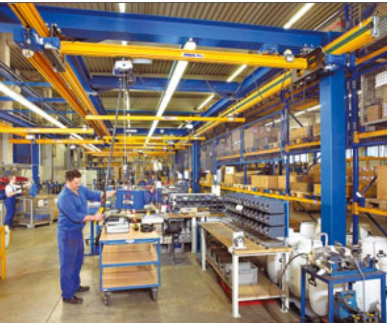
Die HB-Familie von Abus hat jetzt Zuwachs bekommen: EHB-X heißt der neue Einträgerkran, der sich in das bestehende Hängebahnsortiment einreihet. Der Buchstabe X kennzeichnet die aufgebockte Ausführung des Kranträgers, wodurch der Kran laut Hersteller eine optimale Ausnutzung der Hallenhöhe ermöglicht. In der neuen Ausführung hängt der Kranträger nicht – wie bisher – unter, sondern an speziellen Kopfstücken zwischen den
