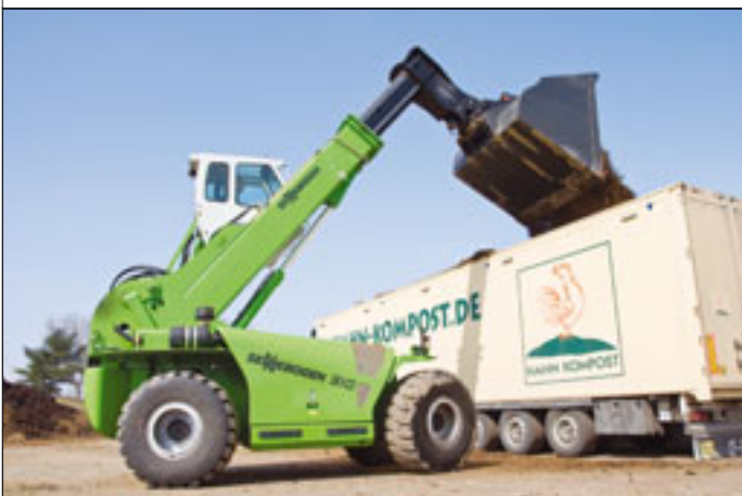
Mit der hochfahrbaren Kabine hat der Anwender im Sennebogen Multicrane 310 einen besseren Überblick
