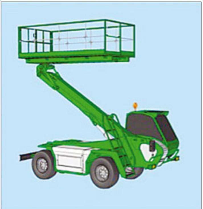
Der italienische Hersteller Merlo hat ein neues Konzept vorgestellt, ein Zwitter aus Teleskop- und Scherenscherenarbeitsbühne. Die Neuheit MPR15/18 ist eine Mischung aus Boomlift und Scherenbühne. Teleskopausleger und scherentypische große Plattform sind aufgebaut auf einem straßentauglichen 4x4x4 Chassis, das dem ähnelt, welches Merlo auch in seine geländegängigen Betonmischer einbaut. 40 km/h flott kann das neue Selbstfah-
