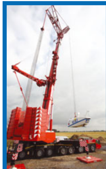
Die Schuch-Gruppe hat sich mit einem Terex AC 500-2 verstärkt. Einsatzpremiere feierte der 500-Tonner in einem Windpark in Willich.
