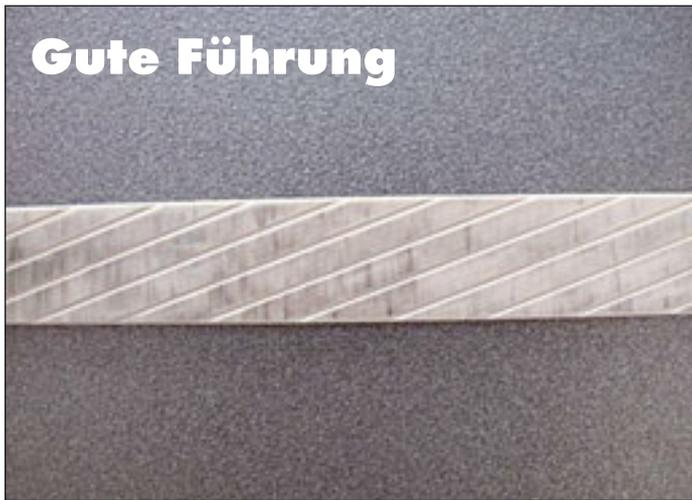
Der Stolberger Hersteller Hoven Hydraulik hat innovative Gebrauchsmuster für extrem beanspruchte Hydraulikzylinder entwickelt. Hydraulikzylinder verfügen über gewebeverstärkte Kunststoffbänder, die Stangen und Kolben möglichst reibungsfrei führen und Querkräfte aufnehmen. Müssen allerdings besonders hohe pulsierende Querkräfte
