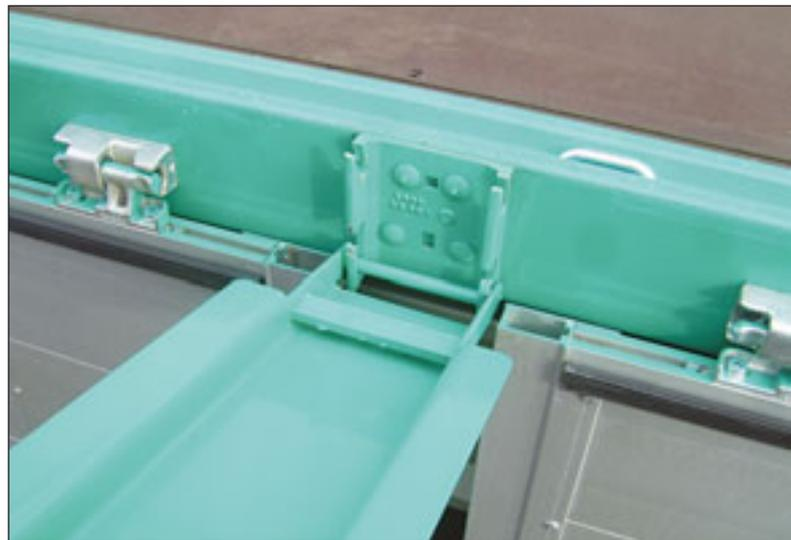
Fliegl rühmt sich, die Runge neu erfunden zu haben. Was steckt dahinter? Ein neuartiges Klapprungensystem, bedienfreundlich und leicht zu reparieren, ist nun für verschiedene Trailer lieferbar. Fliegl ist Gebrauchsmusterinhaber dieser Erfindung. Die Keilrunge mit Klappfunktion sitzt auf einer angeschraubten Aufnahmevorrichtung, wodurch die Konstruktion im Schadensfall rasch ausgetauscht werden kann. Im Gegensatz zu
