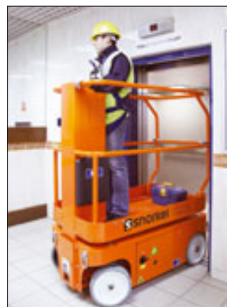
Die TM12 von Snorkel passt durch Standardtüren und in Aufzüge
