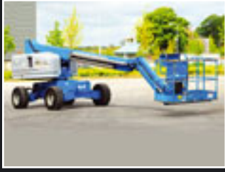
Genie S-45 Teleskopgelenkbühne 15,7m - 2004/5/6/7
