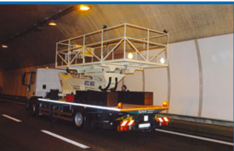
Der italienische Hersteller Barin hat jetzt eine Hubarbeitsbühne vorgestellt, die für Straßeninstandhaltungs- und Tunnelarbeiten prädestiniert ist. Die ATC 850 kann auf einen 12-Tonner aufgebaut werden und reicht bis in Regionen von gut zehn Meter Arbeitshöhe. Die Plattform hat mit 2 x 4,8 Metern fürstliche Ausmaße und kann je nach Modell 500 bis 750 Kilogramm Last an Bord nehmen.
