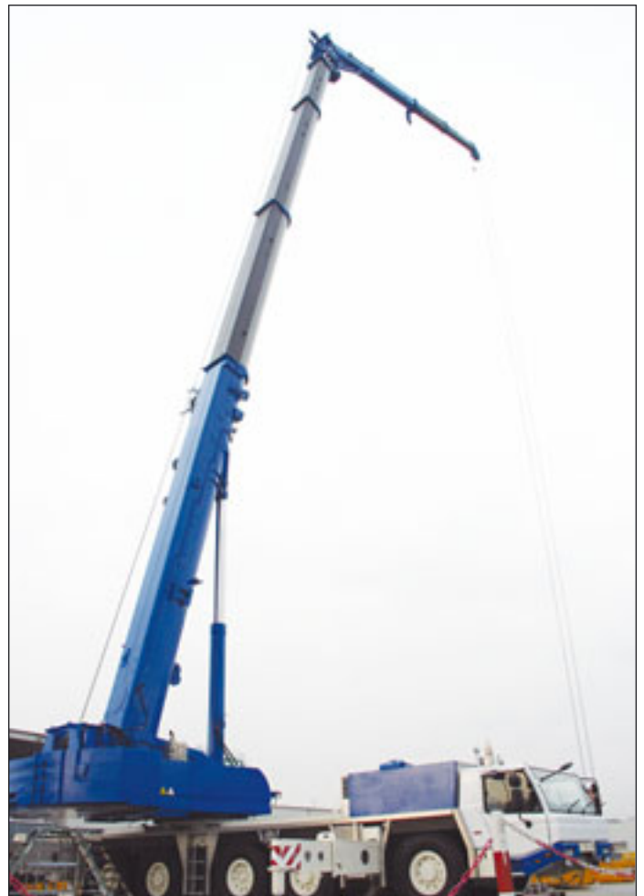
Die neue hydraulische Spitze an einem Tadano ATF 220G-5
