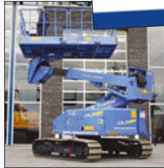
Gut ein Jahr, nachdem die Firma G. M. Damsteegt sich eine Nagano Na180ja zugelegt hat, folgt nun bereits das zweite Modell gleicher Bauart. Das Gelenkteleskop auf Raupenkettensystem bietet eine Arbeitshöhe von 20 Metern und ein breites Deck wie bei großen Scheren mit 600 Kilogramm Tragkraft. Übergeben wurde die neue Bühne von Kemp Hoogwerkers, das die japanischen Maschinen in den Benelux-Staaten vertreibt.
