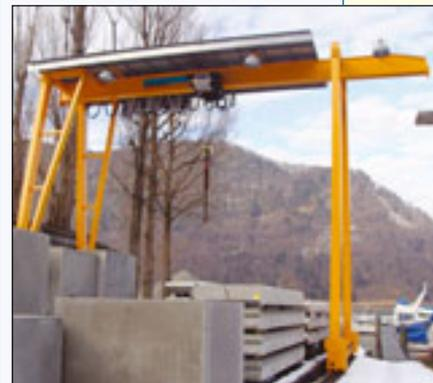
Bei der Steinag Rozloch AG mit Sitz in Stansstad am Vierwaldstätter See hat die Gersag Krantechnik GmbH Ende 2010 einen neuen Portalkran mit einer Tragfähigkeit von zehn Tonnen als Ersatz für einen in die Jahre gekommenen Portalkran montiert. Die Anlage wurde für den Betrieb im Freien ausgelegt und ist unter anderem mit Scheinwerfern und Regendach ausgerüstet. Die Spannweite beträgt zehn Meter und der Überhang auf einer Seite 2,70 Meter.
