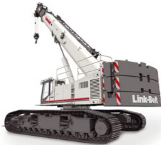
Einen Teleskopraupenkran mit 100 Tonnen Tragkraft will Link-Belt auf der Conexpo enthüllen. Der TCC-1100 ist das dritte Modell in der Teleskopraupen-Baureihe von Link-Belt und wurde dem Unternehmen zufolge bewusst einfach gehalten und soll robust und zuverlässig sein. Mit seinen Traglastkurven können er Gittermastraupen mit vergleichbarer Kapazität Konkurrenz machen, sagt der Hersteller. Der 45,70 Meter lange Hauptausleger kann
