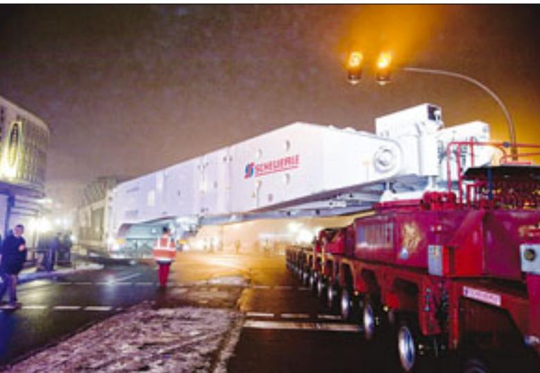
Die Multilift-Gruppe beauftragte Scheuerle mit dem Bau einer Seitenträgerbrücke der Superlative. In kürzester Zeit wurde ein neuer Gigant geschaffen, der STB 1000 mit bis zu 620 Tonnen Nutzlast. Der erste Einsatz war die Überstellung eines Transformators mit 495 Tonnen von Nürnberg nach Wilhelmshaven. Mit 870 Tonnen Gesamtgewicht war dies der größ-
