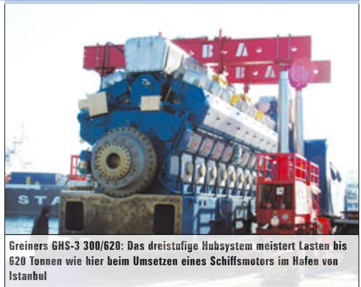
Greiners GHS-3 300/620: Das dreistufige Hubsystem meistert Lasten bis 620 Tonnen wie hier beim Umsetzen eines Schiffsmotors im Hafen von Istanbul
