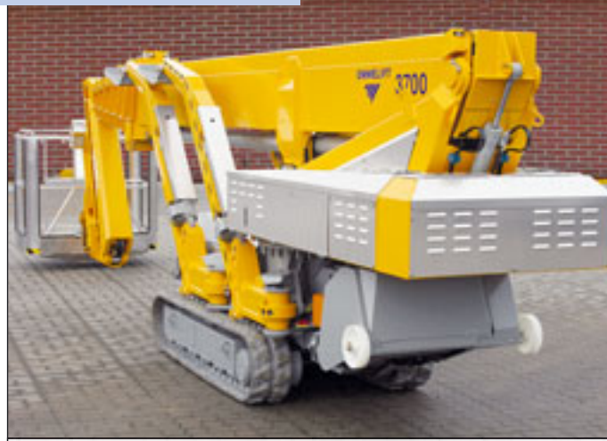
Auf 37 Meter Arbeitshöhe kommt die neue Omme
