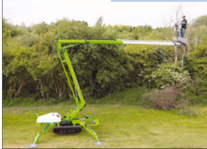
Die Stützen dieser Niftylift gleichen auch abfallendes Gelände aus
