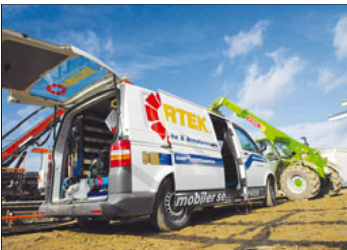
Pirteks mobile Werkstätten stehen rund um die Uhr zur Verfügung. An Bord führen die Servicewagen alle gängigen Schläuche und Armaturen, Schlauchsäge und -presse. So kann ein defekter Hydraulikschlauch noch am Ort des Defektes ausgebaut und erneuert werden.
