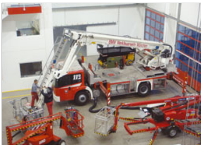
Lift-Manager führt auch regelmäßige Prüfungen durch, wie beispielsweise den planmäßigen 10-Jahres-Checks für die Werksfeuerwehr von BMW München
