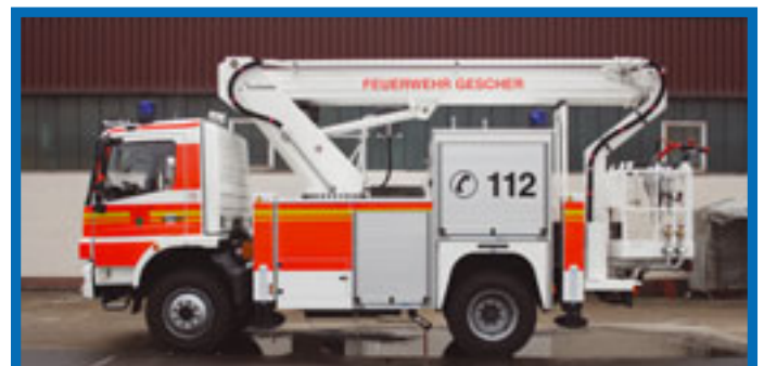
Als Alternative zu teureren Systemen entschied sich die Stadt Gescher für einen Lösch-Rettungs-Steiger von Ruthmann und Iveco-Magirus: die Hubrettungsbühne T 220.1.
