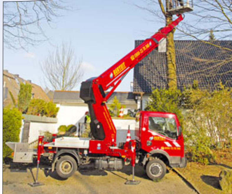
Der Ruthmann TB 270 auf Nissan Cabstar zeigt durch seine kompakten Maße und die variable Abstützung seine Stärken im Innenstadtbereich
