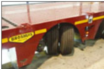
System erhält man eine höhere Nutzlast als bei Aufliegern mit einer Pendelachse. Die Achslast beträgt zwölf Tonnen pro Achslinie, jedoch kann ordentlich zugeladen werden. Außerdem kann ein Reifenwechsel sehr schnell durchgeführt werden – dank Einzelradaufhängung.
