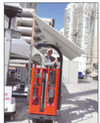
Firmenchef Pierino Bravi stellt einen neuen Lift vor, mit dem sich Gipskartonplatten und Ähnliches mit bis zu 15 Kilogramm Gewicht nach oben bringen lassen
