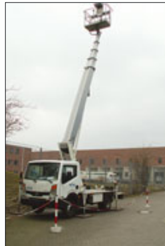
Eine P260B wird im Dauertest auf Herz und Nieren geprüft. Schon weit über 80.000 Mal ist die Bühne aus- und eingefahren und hat definierte Bewegungen durchgeführt.
