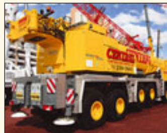
Der Grove GMK6300L verfügt über 300 Tonnen Tragkraft
