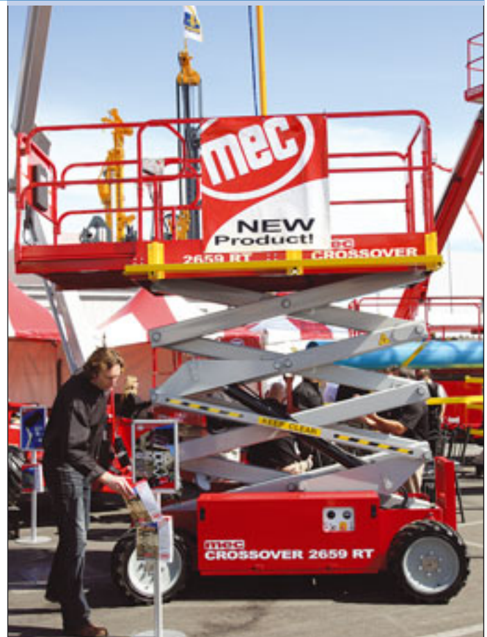
MEC setzt auf Crossover – Innenschere mit einem Hauch Geländetauglichkeit
