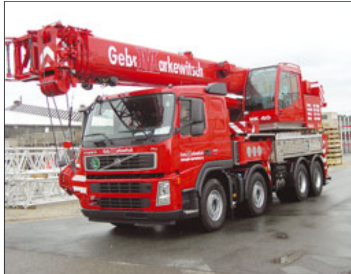
Dank vier Achsen bringt auch der HK40 von Tadano Faun, hier in den Farben von Gebr. Markewitsch, geringere Achslasten auf die Straßen
