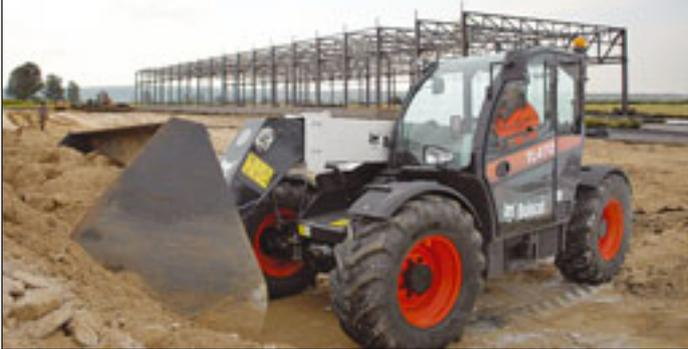
Nach intensiver Entwicklungsarbeit bringt Bobcat mit dem TL360 und dem TL470 eine neue Generation von 6- und 7-Meter-Teleskopen auf den Markt. Neu ist beispielsweise das patentierte asymmetrische Kabinendesign, das einen uneingeschränkten Blick über den Heckbereich bietet, während eine optionale Load-Sensing-Pumpe mit einer Leistung von 190 l/min höhere Geschwindigkeiten bei einfachen und kombinierten Auslegerbewegungen zulässt.
