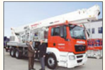
le seitliche Reichweite von 38,3 Meter, die vollvariable Abstützung sowie der um 175 Grad drehbare und auf 3,88 Meter Breite stufenlos ausfahrbare Arbeitskorb mit einer Maximal-Traglast von 600 Kilogramm. Zudem kann mit dem teleskopierbaren Korbarm bis zu sechs Meter unter Flur gearbeitet werden.
