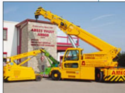
Der italienische Industriekranhersteller JMG hat einen JMG MC600 mit Elektroantrieb an das luxemburgische Vermietunternehmen Ameco geliefert. Der Pick&Carry-Kran soll europaweit eingesetzt werden. Der 60-Tonnen-Kran hat einen 14 Meter langen vollhydraulischen Ausleger, für den ein Patent beantragt worden ist.
