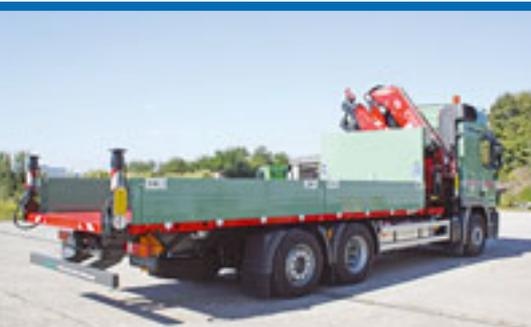
Als „System Pauly“ bietet Fassi Ladekrane jetzt wechselbare Kranaufbauten, die sich besonders für 20-Fuß-Containerfahrzeuge (BDF-Brücke) eignen. Das Trägerfahrzeug wird dabei überhaupt nicht verändert.
