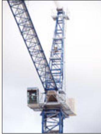
von 12, 18 oder 24 Tonnen. Alle kommen mit 60 Meter langem Ausleger, heben zwischen 2,6 und 3,5 Tonnen an der Spitze und schaffen freistehende Höhen von 53 bis 57 Meter.
