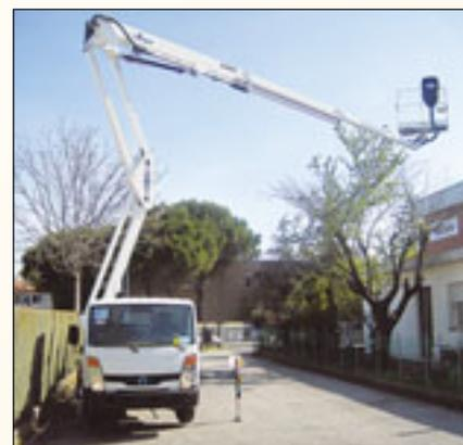
engten Straßenbereich und der große Stützenhub erleichtert die Aufstellung auf ebenem Terrain. Der Gelenkteleskopausleger aus Stahl ermöglicht 10,4 Meter seitliche Reichweite bei voller Korblast sowie 20 Meter Arbeitshöhe. Die vollhydraulische Proportionalsteuerung wurde von den bekannten PX-Modellen übernommen.
