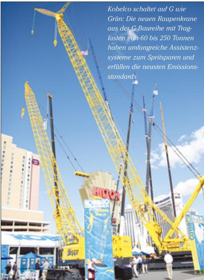
Kobelco schaltet auf G wie Grün: Die neuen Raupenkrane aus der G-Baureihe mit Traglasten von 60 bis 250 Tonnen haben umfangreiche Assistenzsysteme zum Spritsparen und erfüllen die neusten Emissionsstandards
