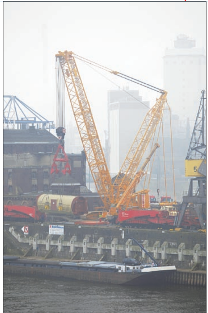
Ein Terex CC 2800-1 von Franz Bracht lädt einen 500-Tonnen Kraftwerksgenerator im Krefelder Hafen von einem Rheinschiff auf einen Spezial-Transporter
