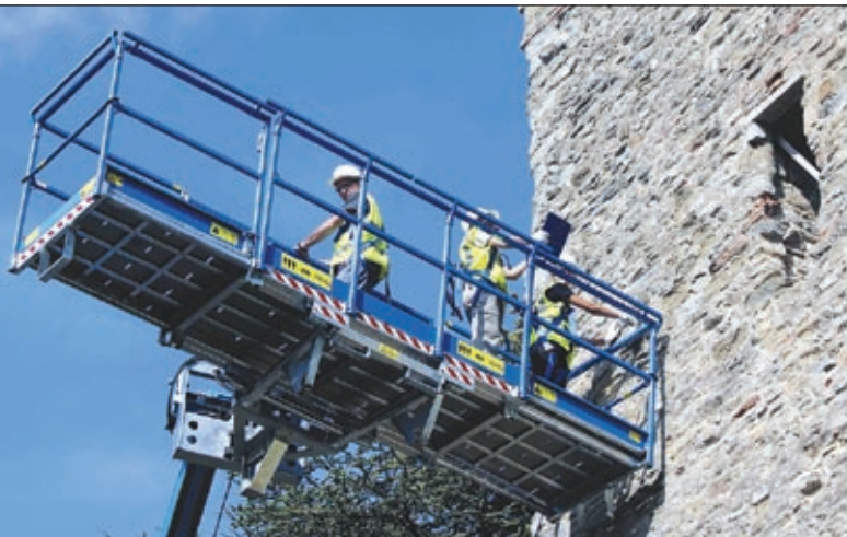
Schwieriger Name, große Tragkraft: Die Genie 3P 700-REM 4400 schultert drei Personen samt Werkzeug
