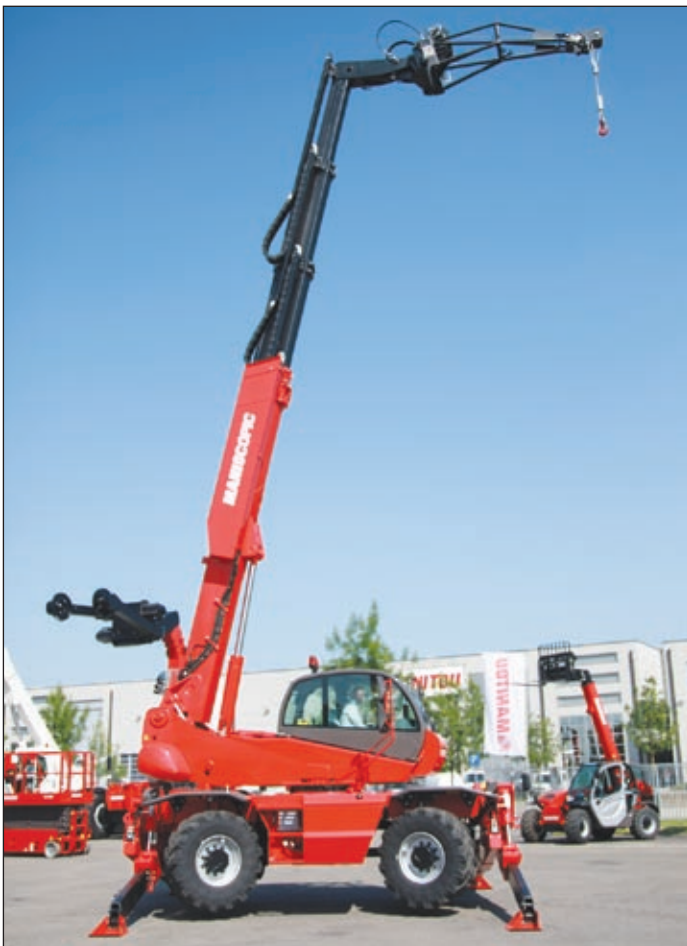
Manitous Größter, der MRT3050, kommt auf über 30 Meter Hubhöhe
