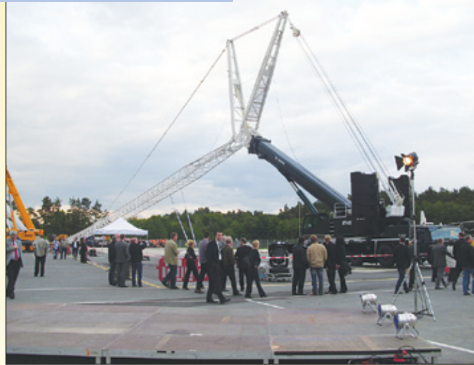
Der neue Große von Tadano Faun mit abgelegter Wippspitze
