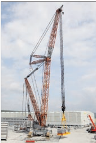
Der LR 13000 im Test, hier mit Wippspitze
