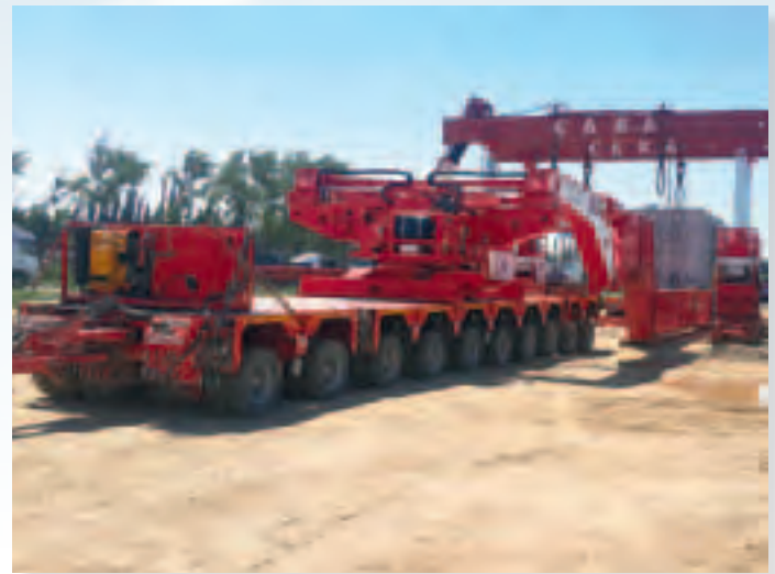
Generatoren mit bis zu 410 Tonnen galt es in der Türkei zu verladen. „CABA“ setzte dabei auch auf eine Scherenhubbrücke von Greiner
