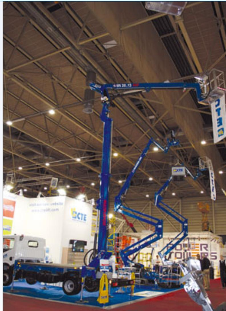
Der Drehpunkt der B-Lift 20.13 MP ist auf dem unteren Teleskop angebracht
