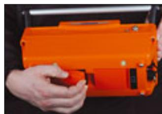
*HBC ermöglicht den Akkuwechsel ohne Stromunterbrechung dank zweier Akkufächer: Das System schaltet dann selbsttätig vom einen auf den anderen um*
