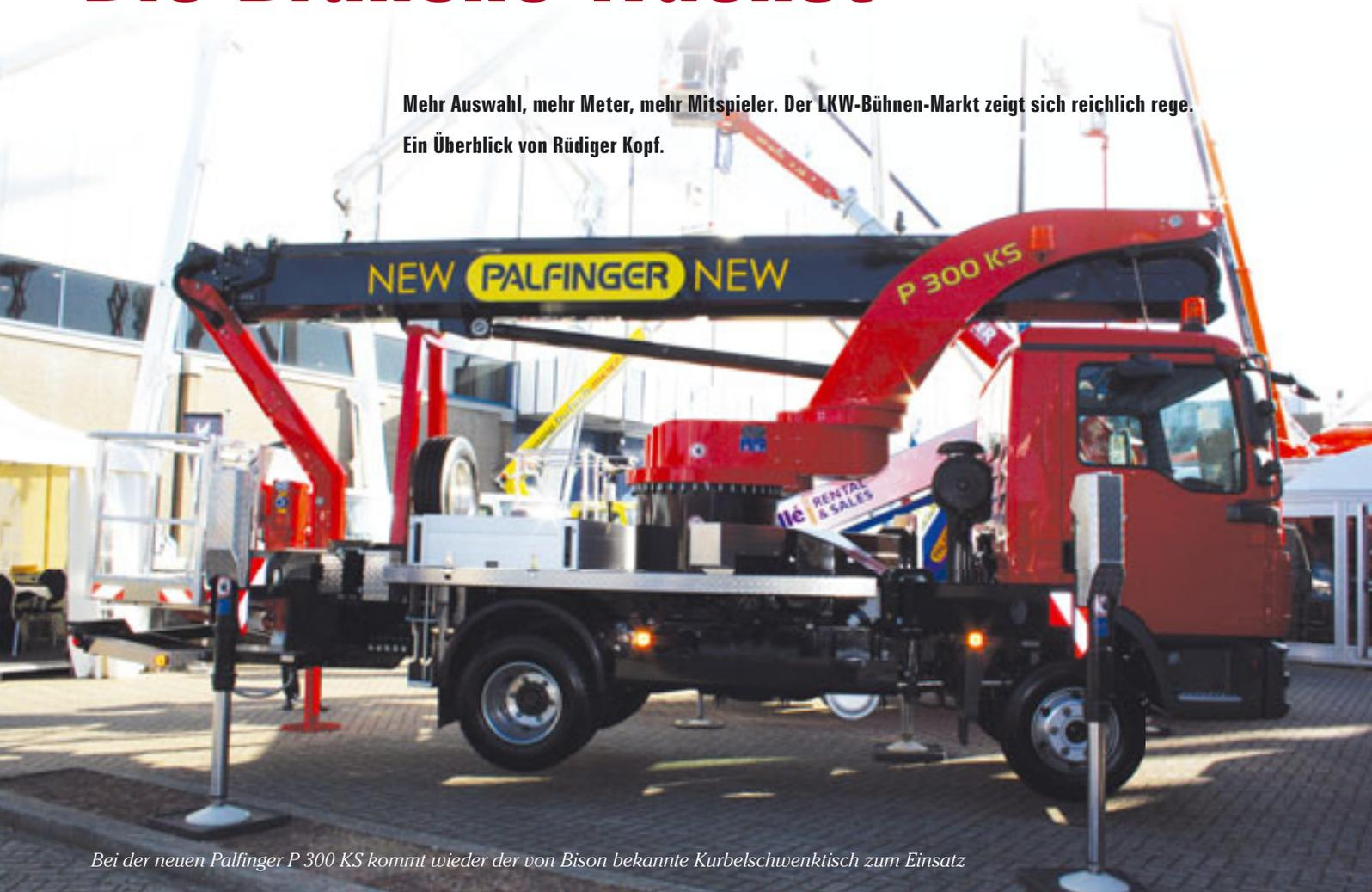
Bei der neuen Palfinger P 300 KS kommt wieder der von Bison bekannte Kurbelschwenktisch zum Einsatz
