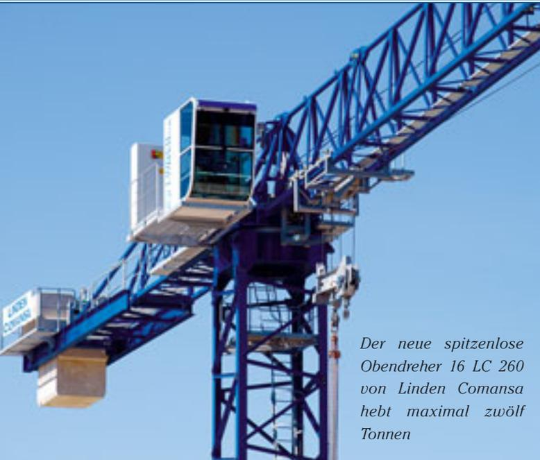
Der neue spitzenlose Obendreher 16 LC 260 von Linden Comansa hebt maximal zwölf Tonnen
