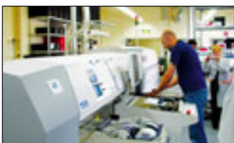
Dank modernen Bestückungsmaschinen können Steuereinheiten ganz nach Wunsch des Kunden produziert werden
