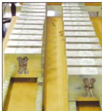
In dieses Aluminiumbauteil wird später das Herzstück der Korblastüberwachung eingebaut
