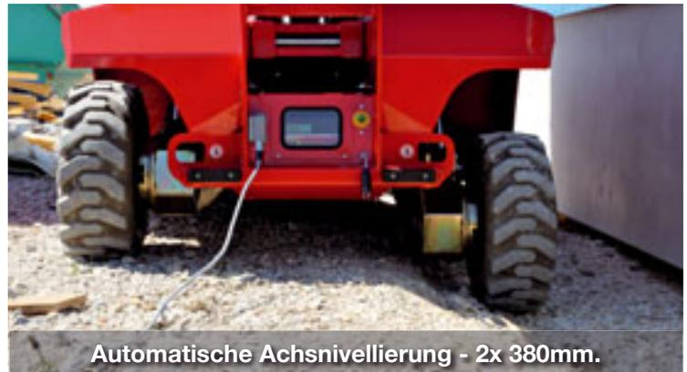
Automatische Achsnivellierung - 2x 380mm.
