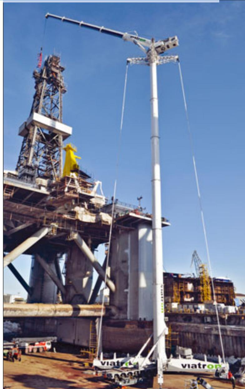
Im Trockendock angekommen, half der GTK, Lasten auf bis zu 116 Meter Höhe zu heben
