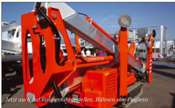
Die neue HX195 mit Aluminium-Teleskopauslegern
