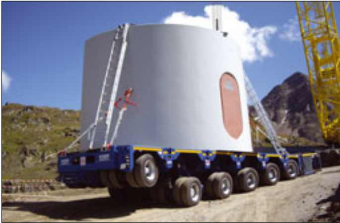
40 Tonnen Betonturm-Halbschale mit gelifteter erster Achslinie
