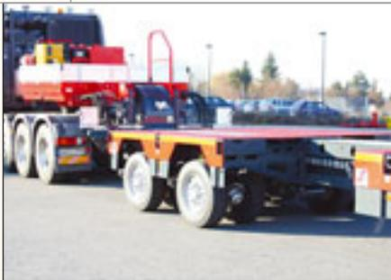
hersteller Scheuerle und dessen Schwesterfirma Nicolas aus Frankreich einen neuen Typ Semi-Trailer mit hydraulisch verschiebbaren Achsen vor. Erhältlich sind neben der Standardversion weitere Ausführungen wie „einfach teleskopierbar“ und „zweifach teleskopierbar“. Wie der Name „Superflex“ schon deutlich macht, bieten die Semi-Tiefelader ein hohes Maß an Flexibilität. So ist es möglich, bei Fahrzeugen mit einfacher Teleskopstufe, die
