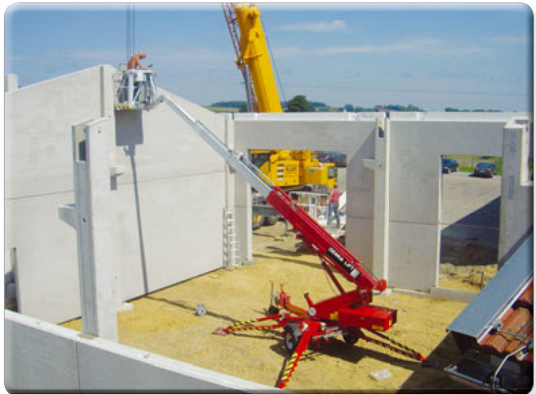
Durch ihre leichte Manövrierbarkeit können Anhängerbühnen wie diese Denkalift DK 18 leichter und manchmal näher an die Einsatzorte gebracht werden
