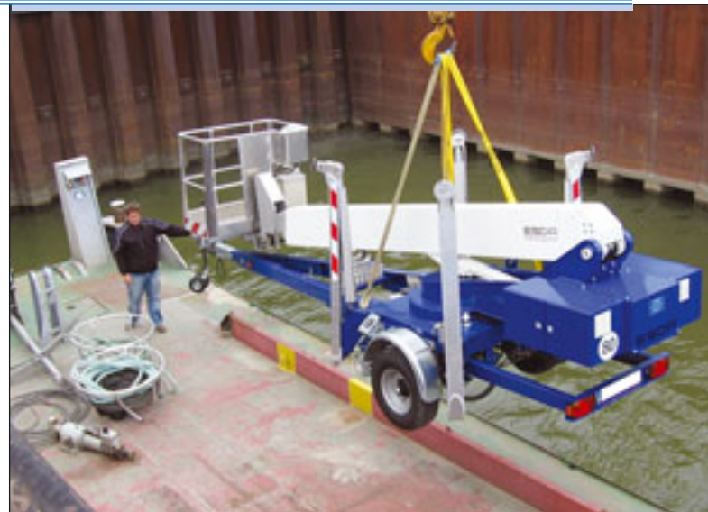
Zur Wartung von Brücken und Schleusenanlagen sowie zur Pflege von Böschungen wird diese Esda-Anhängerbühne per Kran an ihren Kranösen auf eine schwimmende Arbeitsplattform eingehoben
