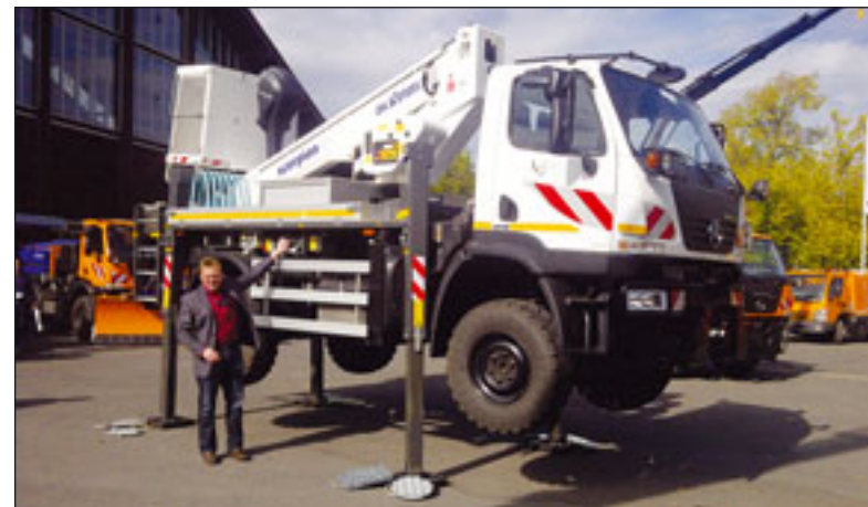
Aufgebaut auf einem Unimog U20, bietet diese Oil&Steel nicht nur eine hohe Abstützhöhe, sondern noch etliche Extras
