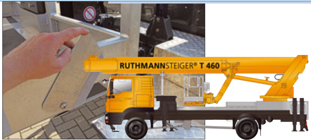
Mit der T460 kommt Ruthmann im Frühjahr auf den Markt. Für seine Arbeitskörbe bietet das Unternehmen zur leichteren Reinigung Abflussklappen an.
